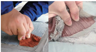
无处理APF-5000与水泥砂浆的剥离强度测试（内聚破坏，标准值为1.5,典型值可达到3.0）
