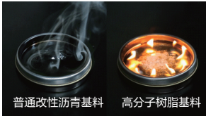
两种材料燃烧后，普通改性沥青基料产生大量沥青烟，高分子树脂仅产生少量气体，结果可见，高分子树脂更加环保。
