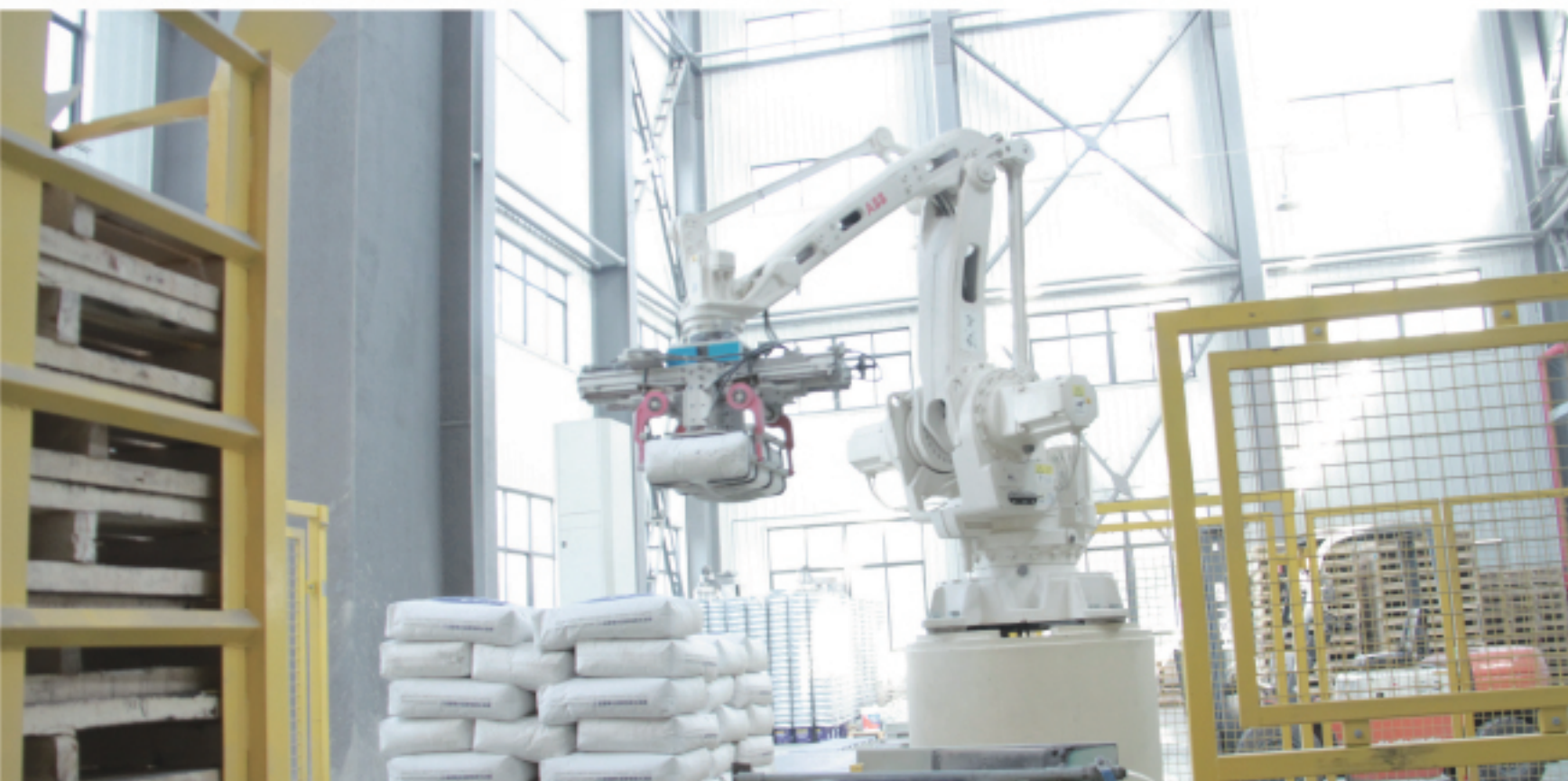
自动化码垛机操作
